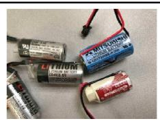
発火したと思われる ER 電池(塩化チオニルリチウム電池) ※この電池は電子機器類に組み込まれている事が多いです
